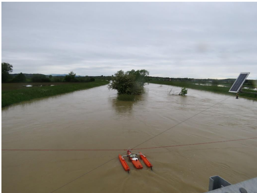
Slika 5. Hidrometrična meritev na Pesnici v Gočovi ob visokovodnem dogodku 17. maja 2023
