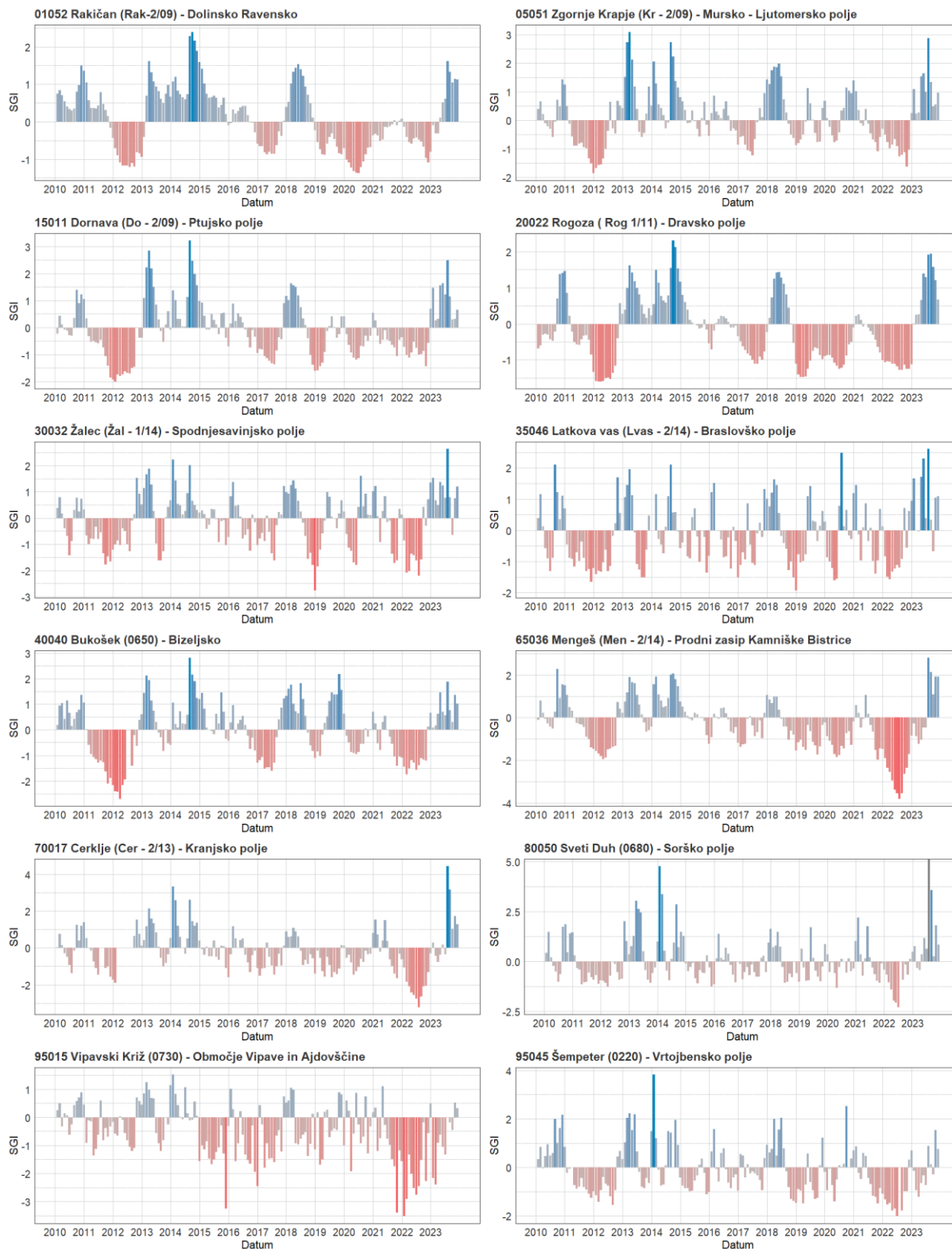
Slika 4. Potek standardiziranega indeksa povprečnih mesečnih gladin podzemne vode (SGI) od leta 2010 na izbranih merilnih mestih. Več na povezavi: http://www.meteo.si/met/sl/watercycle/diagrams/sgi/ Figure 4. Standardized mean monthly groundwater level values (SGI) from 2010 on selected measuring locations. More information is available on http://www.meteo.si/met/sl/watercycle/diagrams/sgi/
