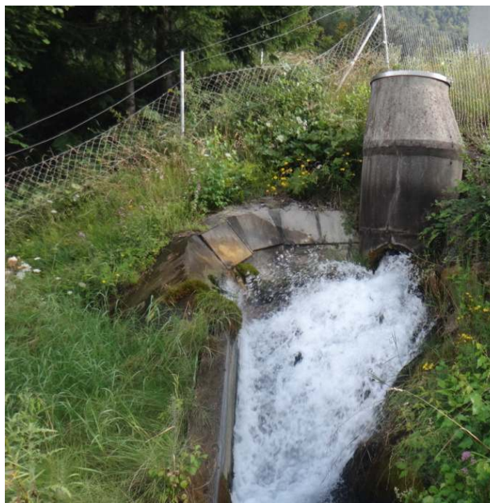
Slika 1. Merilna postaja za spremljanje iztoka podzemne vode iz cestnega predora Karavanke (Foto: Arhiv ARSO) Figure 1. Measuring station for groundwater discharge measurements from road tunnel Karavanke (Photo: ARSO archive)
