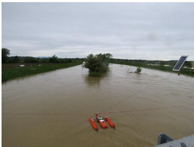
Slika 7. Hidrometrične meritve na Pesnici v Gočovi ob visokovodnem dogodku 17. maja 2023. Figure 7. Hydrometric measurements at Pesnica in Gočova during the high water event on May 17, 2023
