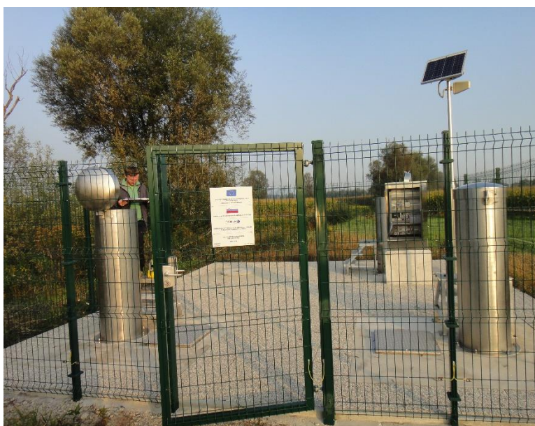
Slika 7. Merilna postaja za meritev podzemnih voda lška Loka Figure 7. Measuring station lška Loka
