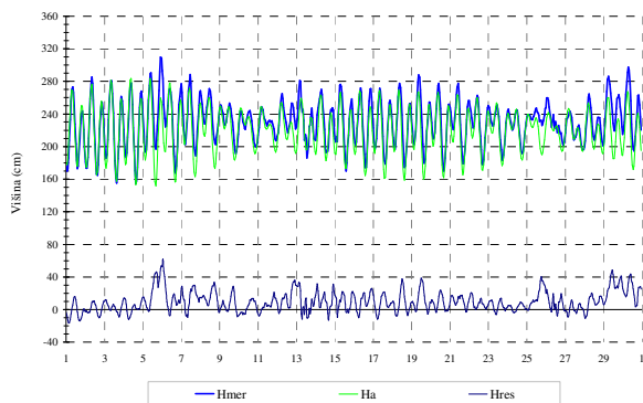
Slika 3. Izmerjene urne (Hmer), astronomske (Ha) in residualne (Hres) višine morja v novembru 2017. Srednja letna višina morja v dolgoletnem obdobju je 217 cm. Figure 3. Measured (Hmer), astronomic (Ha) and residual (Hres) sea levels in November 2017
