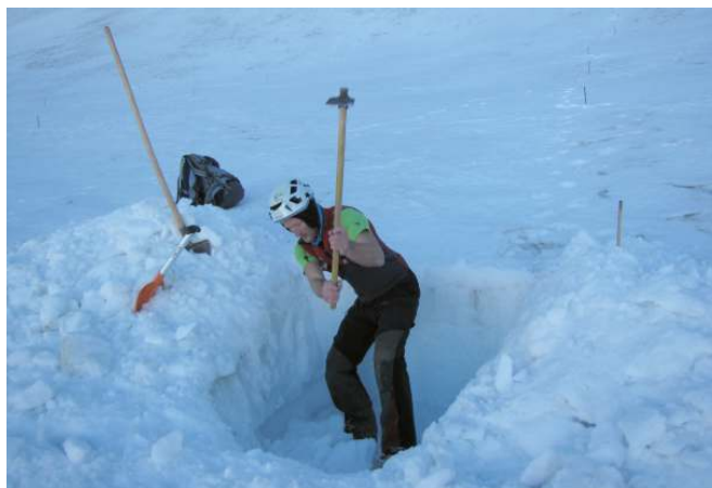
Slika 3. Odkop ledeniškega prereza za vzorčenje snega oz. ledu (foto: Matija Zorn) Figure 3. Excavation of the glaciers profile for snow and ice sampling (Photo: Matija Zorn)
