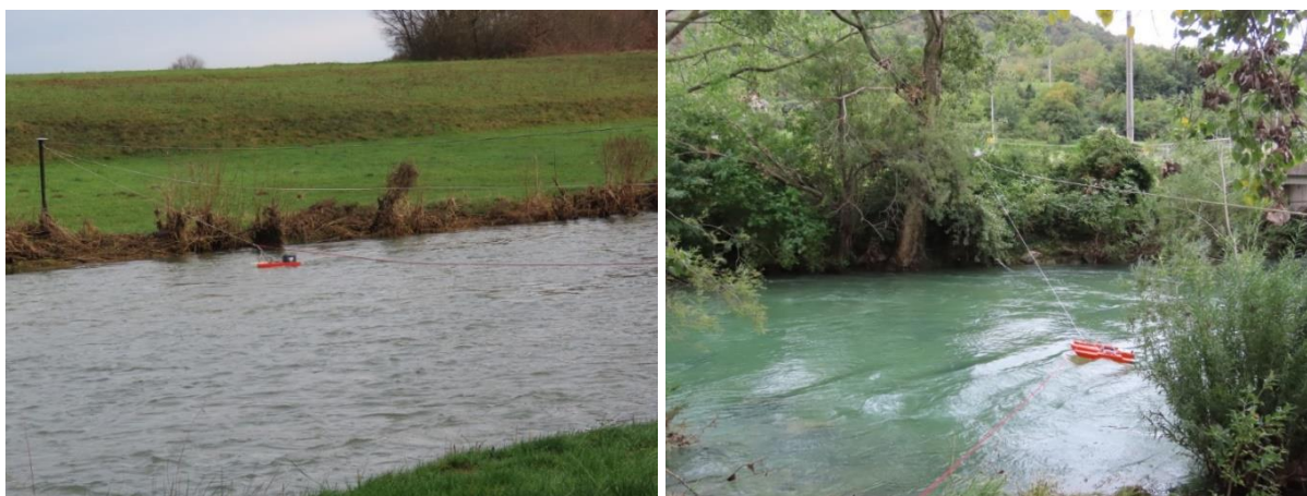
Slika 2.2: Meritev pretoka s pomočjo vrvene premostitve na vodomerni postaji Podbukovje I in vodomerni postaji Dolenje (fotografija: arhiv ARSO)
