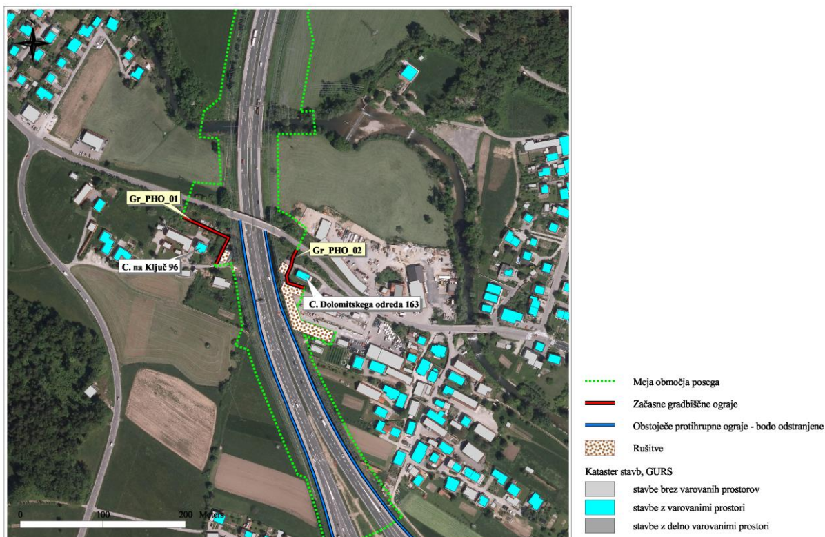
Slika 12: Predlog začasnih protihrupnih ograj v času gradnje AC odseka Koseze-Kozarje
