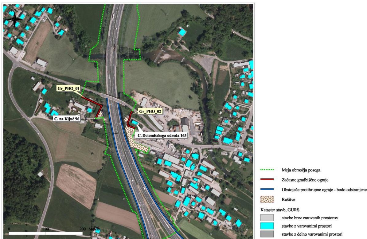
Slika 8: Predlog začasnih protihrupnih ograj v času gradnje AC odseka Koseze-Kozarje
