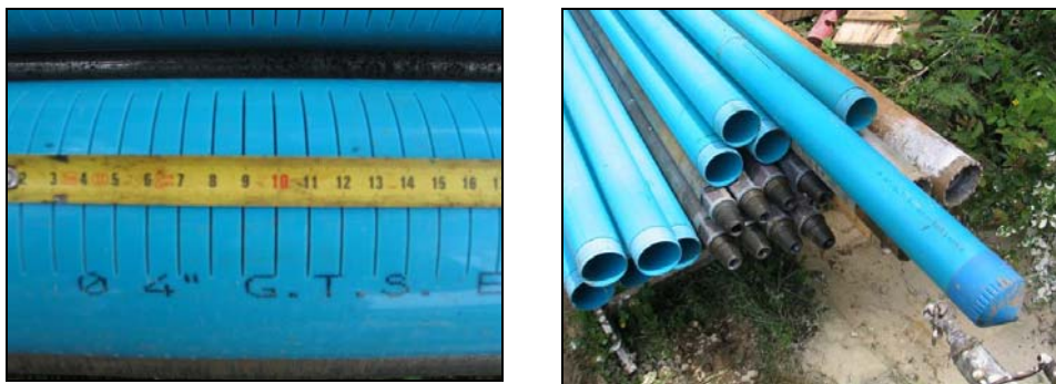
Slika 4: Vgrajene plastične (PVC) cevi notranjega premera 101,6 mm in usedalnik s čepom.
