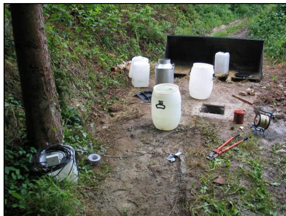
Slika 7: Oprema za izvedbo nalivalnega poskusa.
