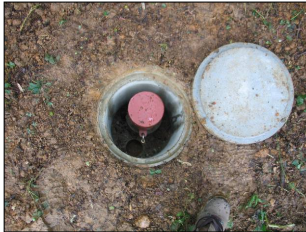
Slika 6: Ureditev ustja piezometrov s povoznim jaškom.
