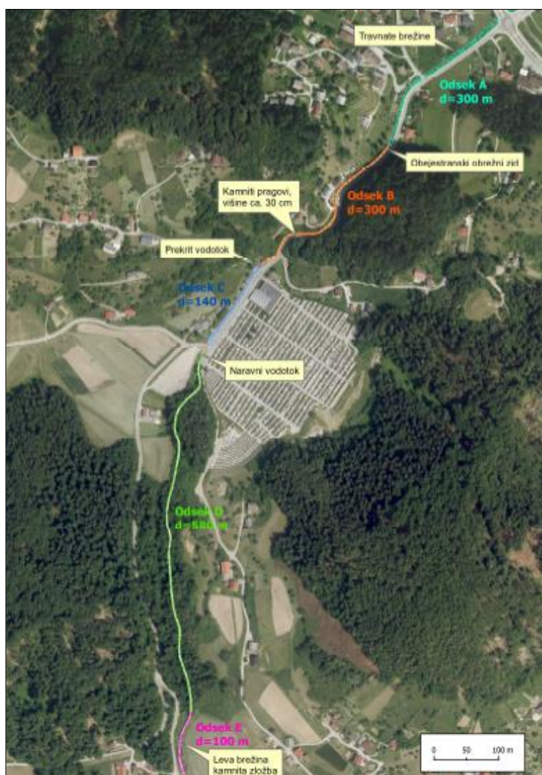
Slika 43: Pregledna karta vodotoka Veriželj in razdelitev po obravnavanih odsekih (vir: Ocena ekološkega stanja in ocena vplivov gradnje in obratovanja na potok Veriželj, Vodnogospodarski biro Maribor d.o.o., oktober 2017)
