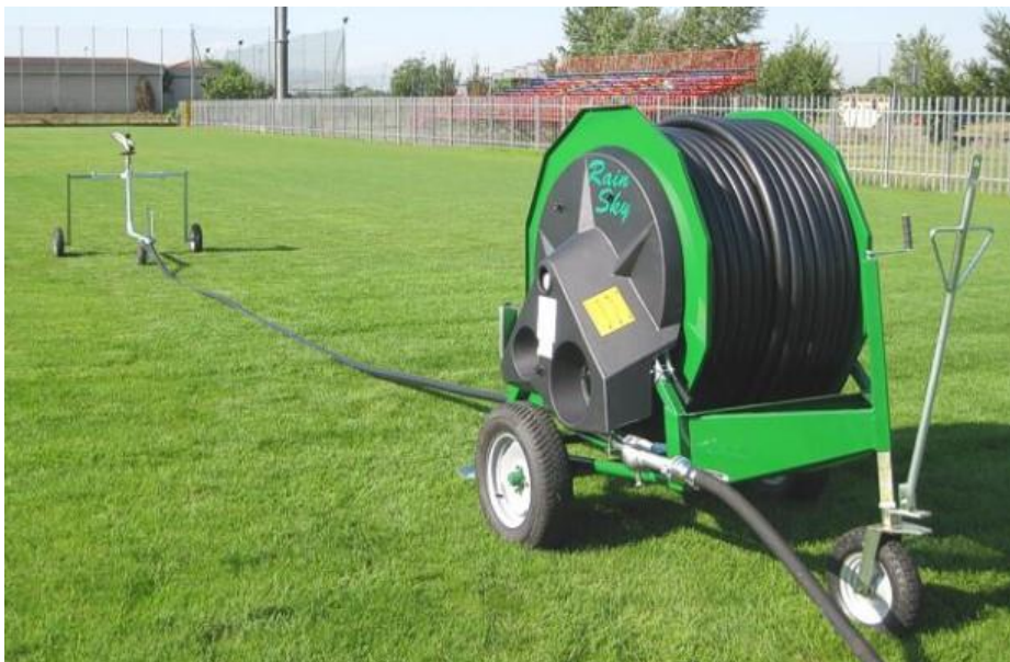
Slika 5: Bobnasti namakalnik s pršilnim vozičkom, ki ga namakalnik počasi vleče proti sebi
