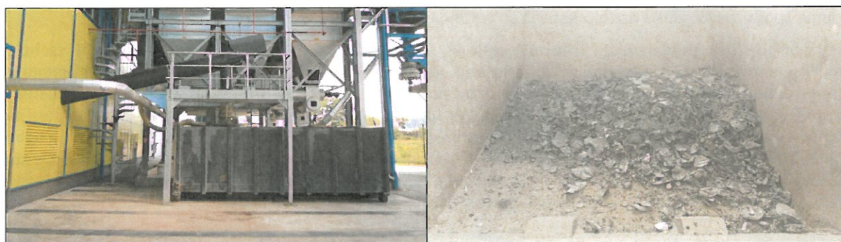
Slika 82: Zaprti kontejner za ogorki in žilindro ter kontejner z izločenimi kovinskimi delci [vir: EIMV]
