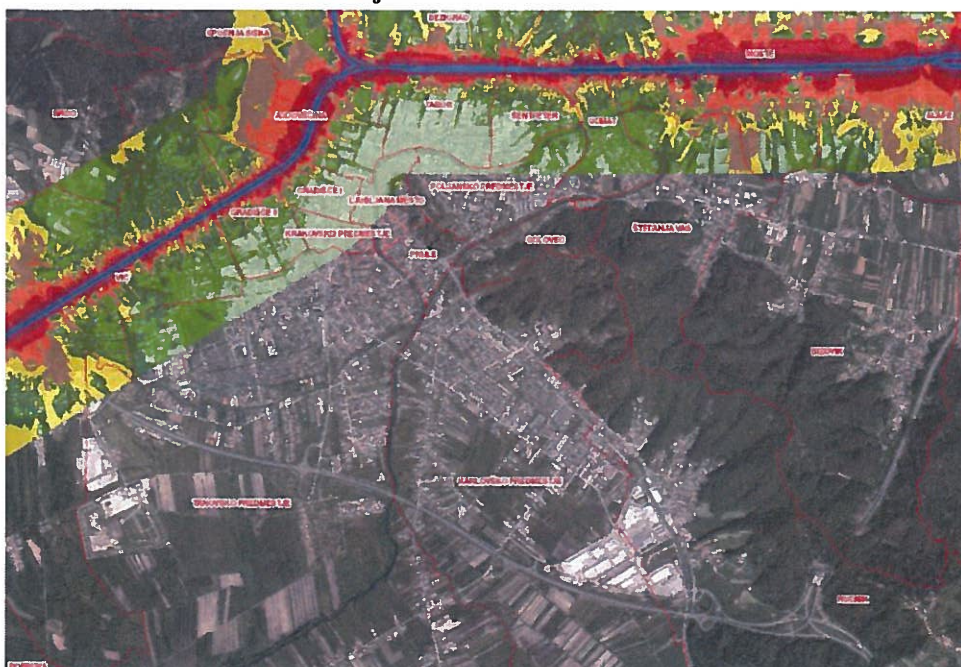
Slika 4.9: Pomembni obstoječi viri hrupa na območju obravnave hrupa DV 2×110 kV Polje-Vič – Železniške proge L_{dvn} .
