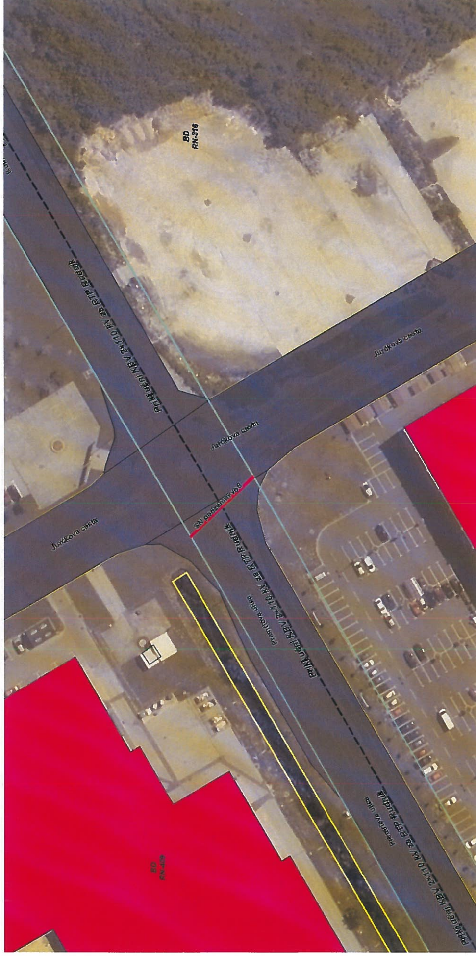
Slika 5.17: Celotna obremenitev priključnega KBV 2 \times 110 kV za RTP Rudnik in obstoječih SN KBV na križišču Premrllove in Jurčkove ulice.
