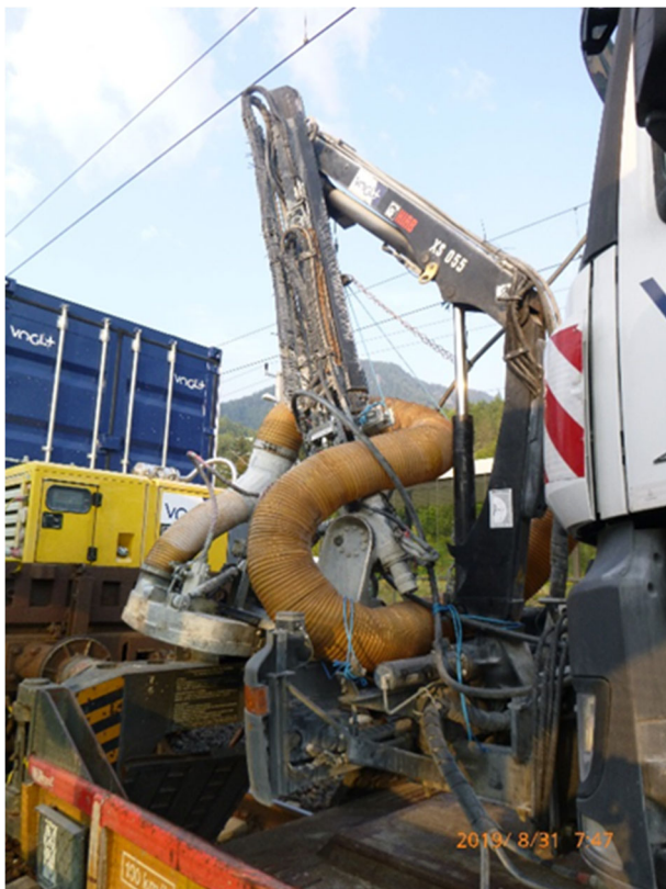
Slika 6-5: Robot za čiščenje z vodo pod visokim pritiskom s sesalnim zvonom
