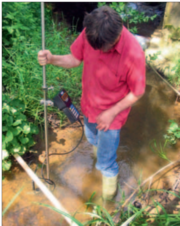
Meritev z akustičnim hidrometričnim krilom na v. p. Središče – Ivanjševski potok (foto: Barbara Cankar, maj 2006).
