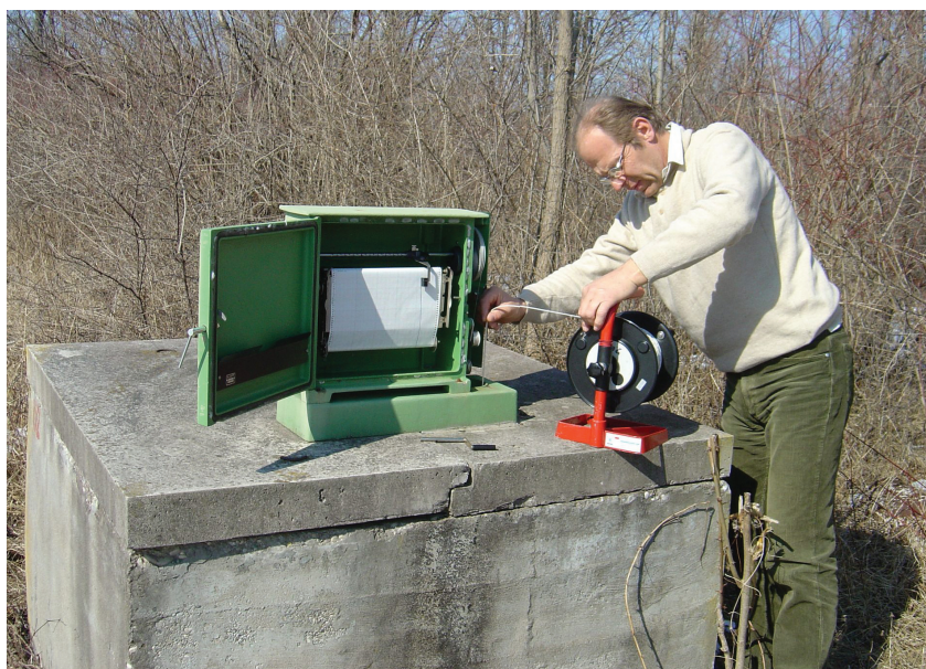
Izvajanje meritev podzemne vode na Krškem polju (foto: Niko Trišić). Groundwater level measurement at Krško polje (photo: Niko Trišić).
