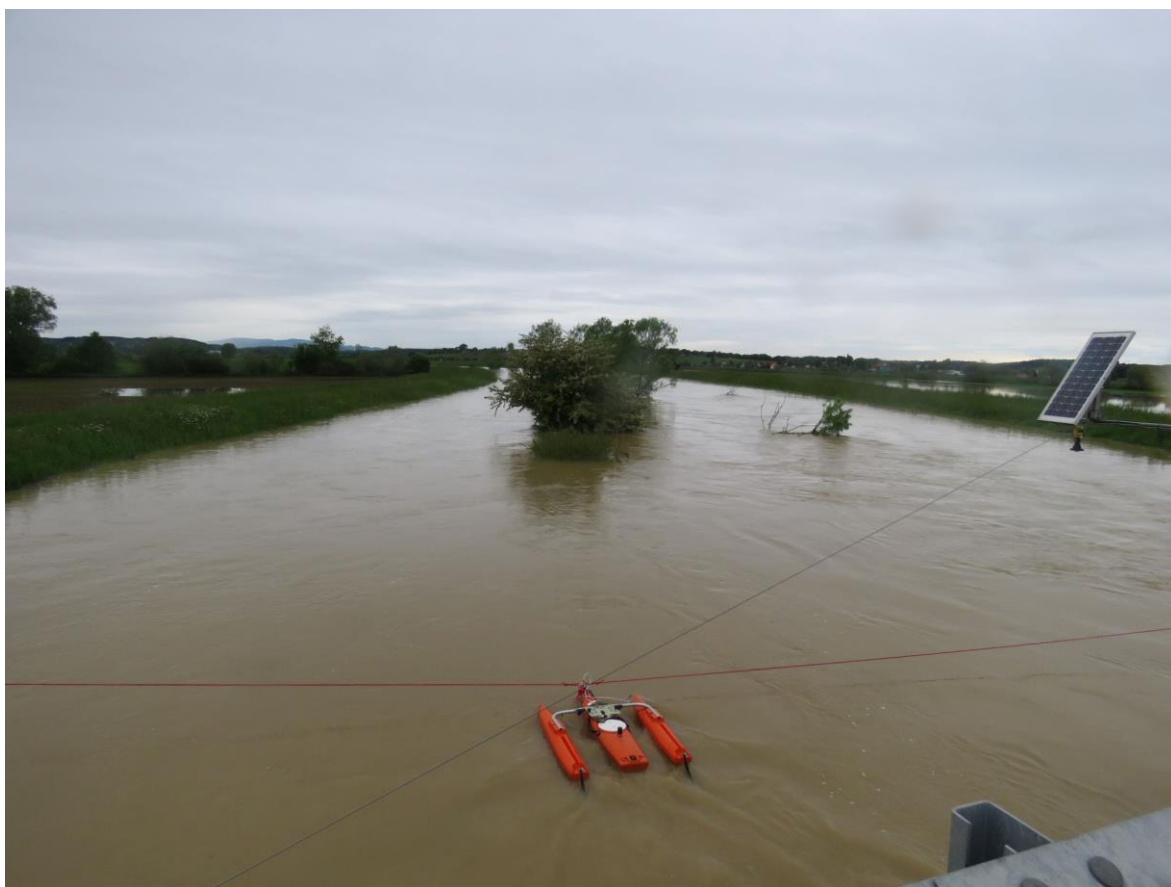
Slika 2.2: Hidrometrična meritev na Pesnici v Gočovi ob visokovodnem dogodku 17. maja 2023 (fotografija: arhiv ARSO)
