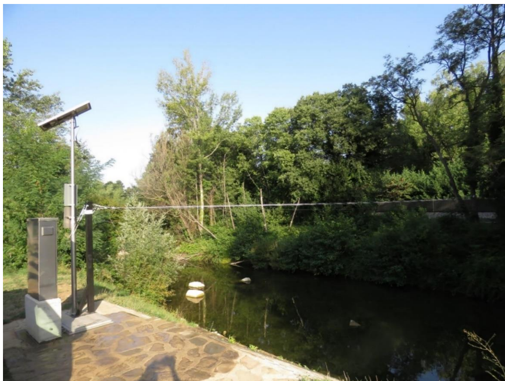
Slika 4: Postavitev začasne vrne premostitve za izvajanje meritev pretoka visokih voda v Dekanah na Rižani (foto: Primož Gajser)
