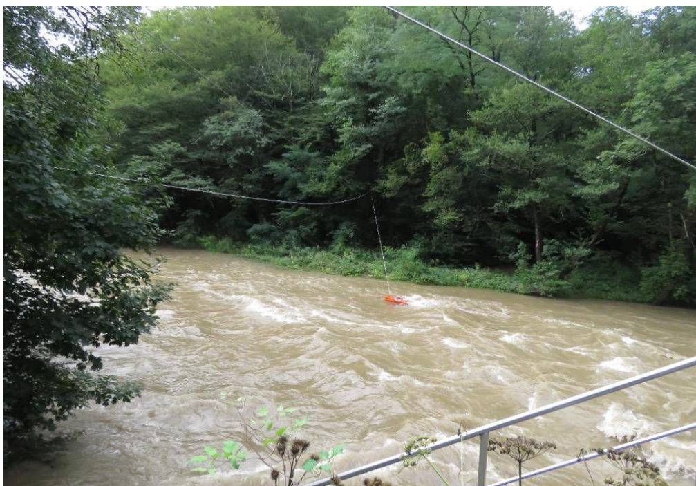
Slika 5: Meritev pretoka visoke vode s pomočjo vrne premostitve v Škocjanu na Reki 16.9.2017 z ADCP merilnikom (foto: Primož Gajser)
