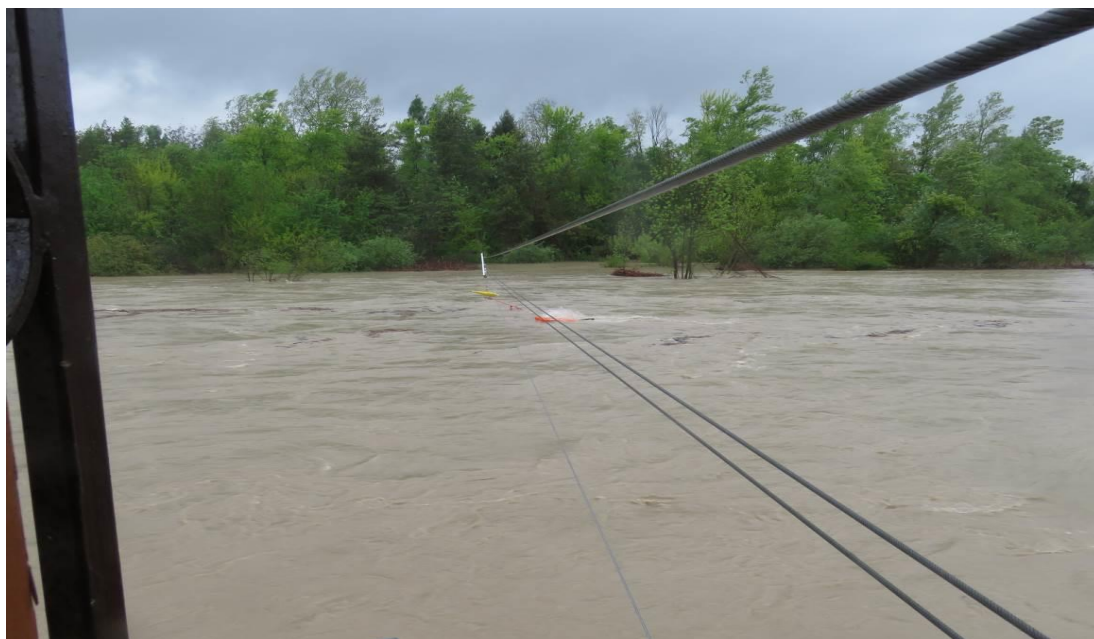
Slika 18: Meritev pretoka visoke vode Save v Šentjakobu 28. aprila 2017 (foto: arhiv ARSO)
