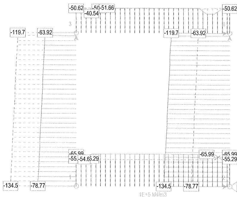
Diagram osnih sil, ki pripadajo ovojnici upogibnih momentov. Sile so v kN.
