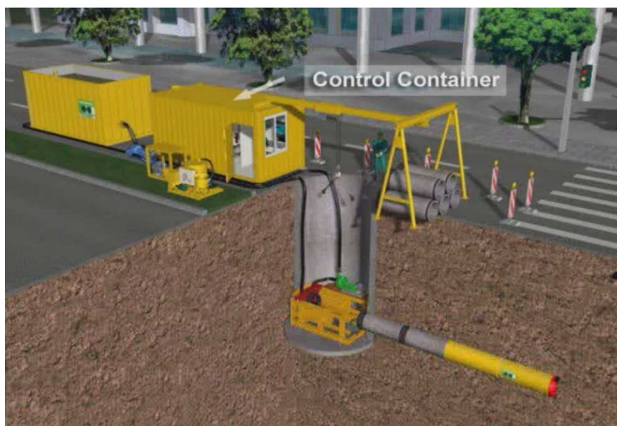
Slika 6: Prestavitev kanalizacijskega zbiralnika z metodo mehaniziranega podzemnega izkopa
