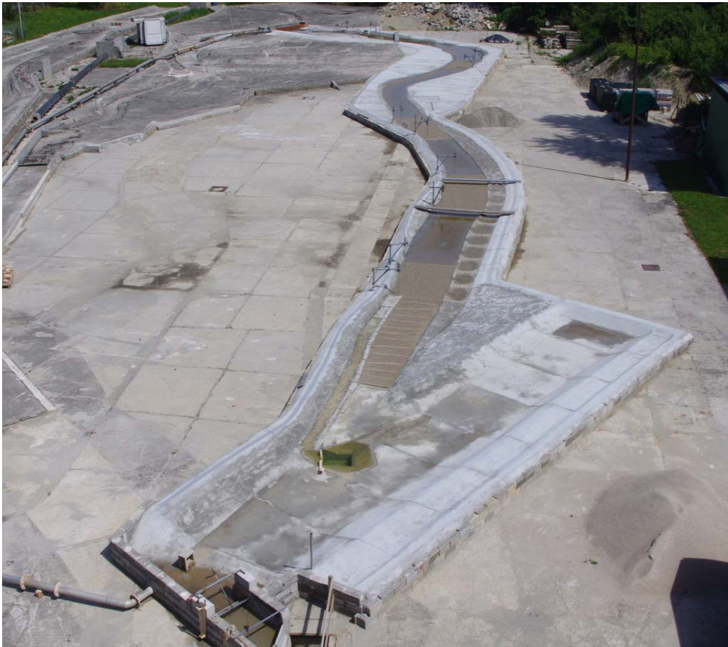
Slika 2.1: Fizični model izlivnega odseka Krke v merilu 1:30.
