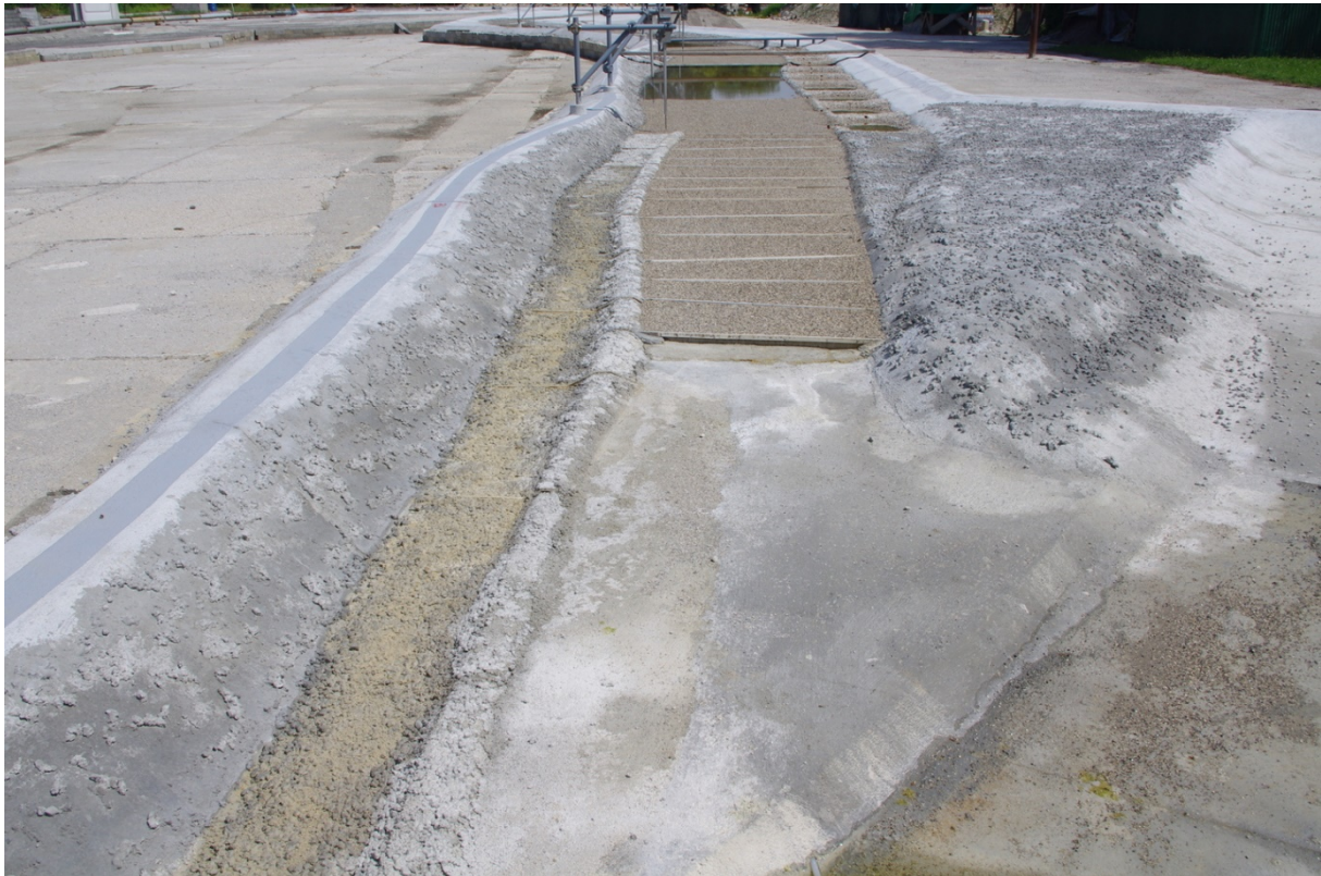
Slika 2.2: Drstišče 1, razširitev s kotanjami na LB ter ribja steza na DB s kaskadnim odsekom na fizičnem modelu izlivnega odseka Krke.
