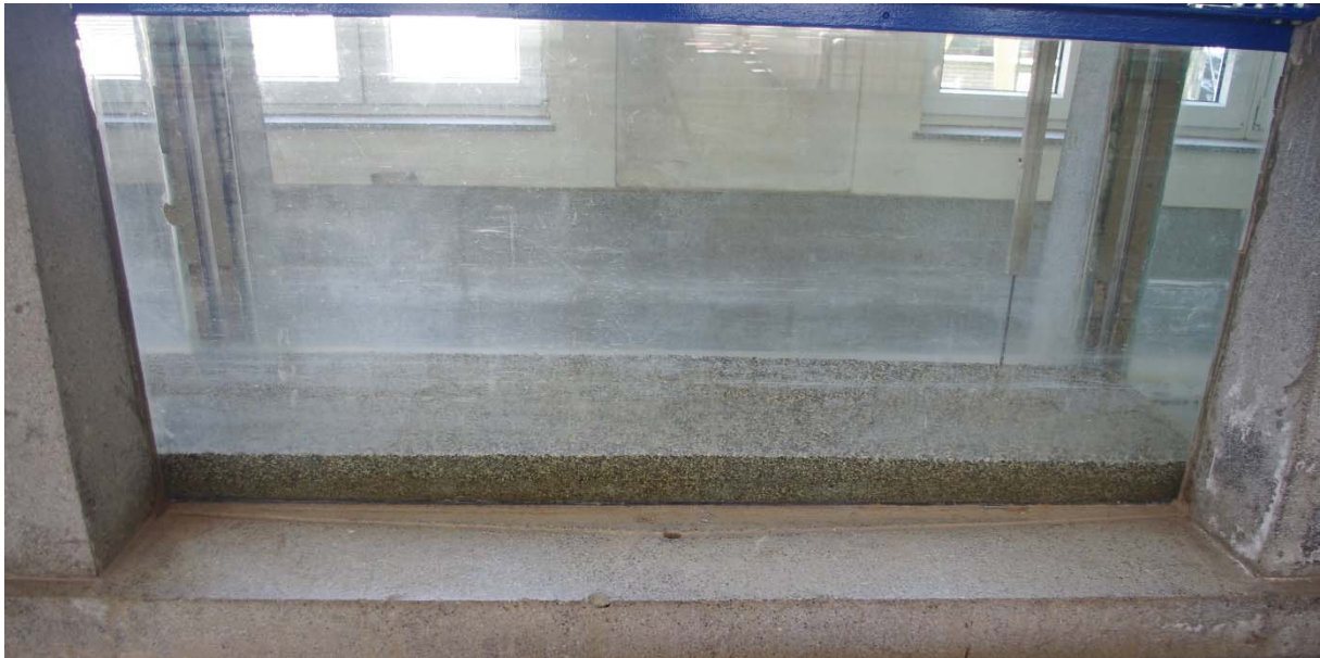
Slika 3.2: Preizkus gibljivosti modelnega proda v hidravličnem žlebu.
