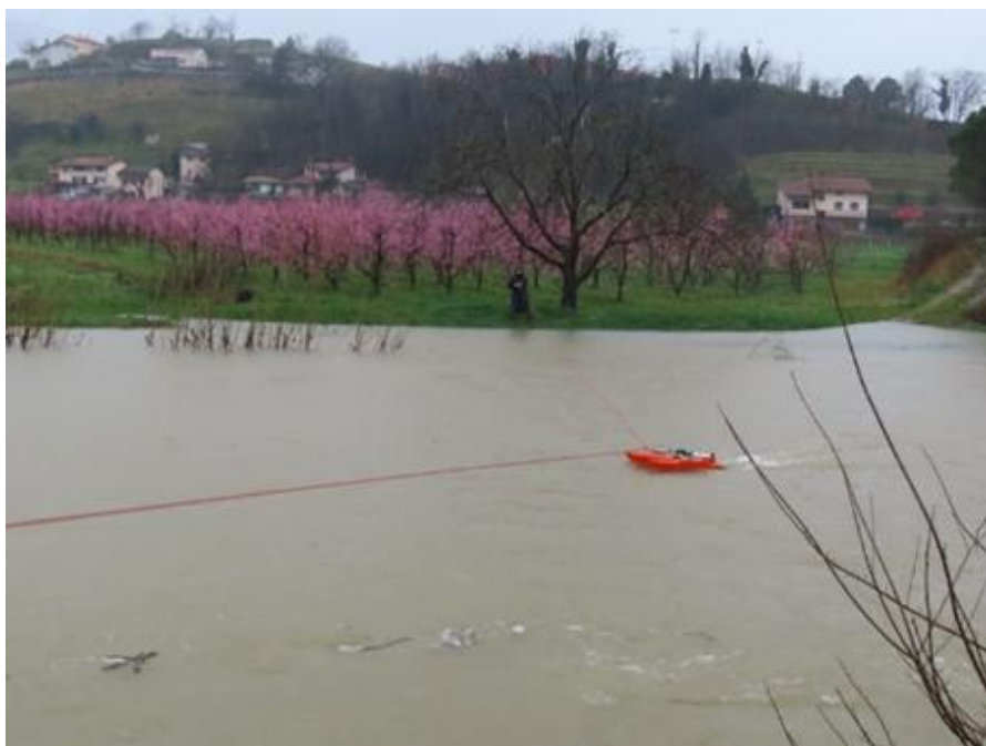
Slika 5. Izvajanje hidro-metrične meritve preto-ka med razlivanjem Vi-pave v Zaloščah, 14. marca 2025 (foto: arhiv ARSO) Figure 5. Hydrometric flow measurement du-ring flooding of the Vipa-va River in Zalošče, 14 March 2025 (photo: Archive ARSO,)
