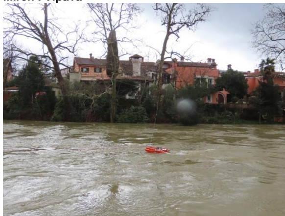
Slika 8. Hidrometrične meritve na vodomernih postajah v porečjih Ljubljanice in Vipave, opravljene med 14. in 15. marcem 2025.
