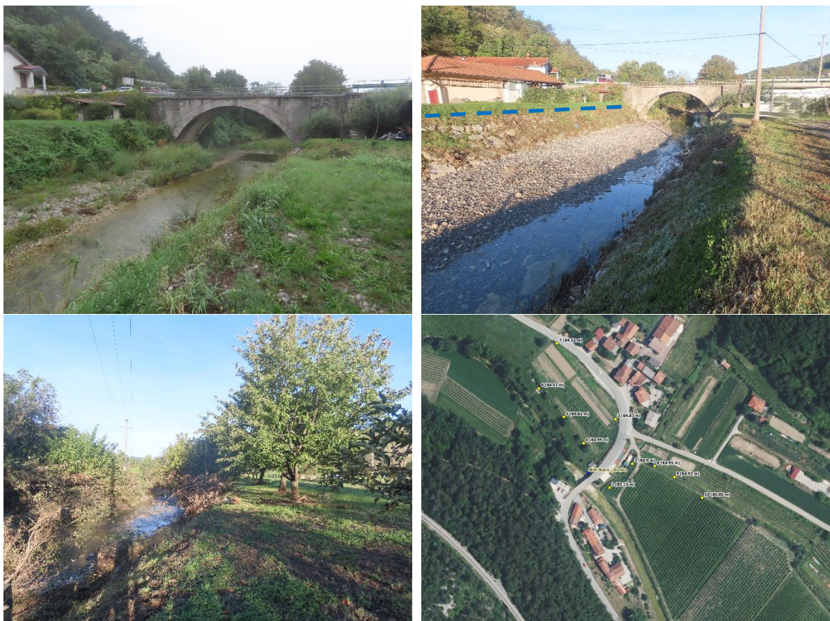
Slika 6. Vodomerna postaja Branik na Branici 17. septembra, pred visokovodnim dogodkom (zgoraj levo), stanje 16. oktobra po visokovodnem dogodku z označenimi sledmi visoke vode gorvodno od vodomerne postaje (zgoraj desno), sledi visoke vode dolvodno od vodomerne postaje (spodaj levo) in označene višinske točke posnetih sledi visoke vode na širšem območju vodomerne postaje (spodaj desno) (fotografije: arhiv ARSO)
