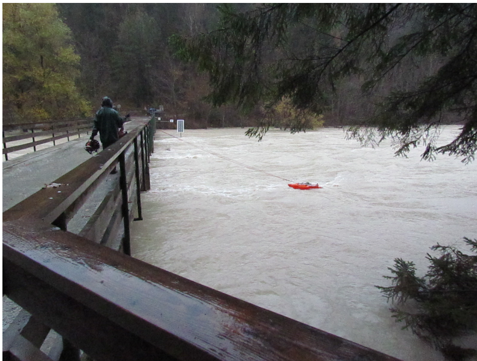
Slika 2: Meritev pretoka visoke vode 5. novembra 2012 v Bodeščah na Savi Bohinjki (foto: Marko Burger)
